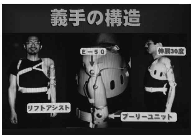
図9 上腕部の振り動作機構を付けた肩義手
